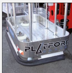
Leitfähiges Gummikollisionschutzgerät, das am Arbeitskorb angebracht ist.
